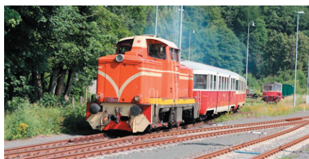
Lokomotiva ze speciálním Abtovým ozubnicovým systémem, který je použit na ozubnicové trati z Tanvaldu do Harrachova. Foto: Aneta Rolníková.
